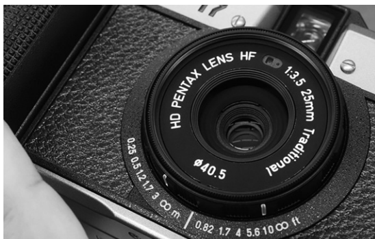
レンズは25ミリF3.5（35ミリ判換算、37ミリ相当）の固定式単焦点レンズ。3群3枚構成に9枚羽根の絞りとHDコーティングを採用。ゾーンフォーカスに連動する距離目盛が下に見える。（撮影：柴田 誠）
